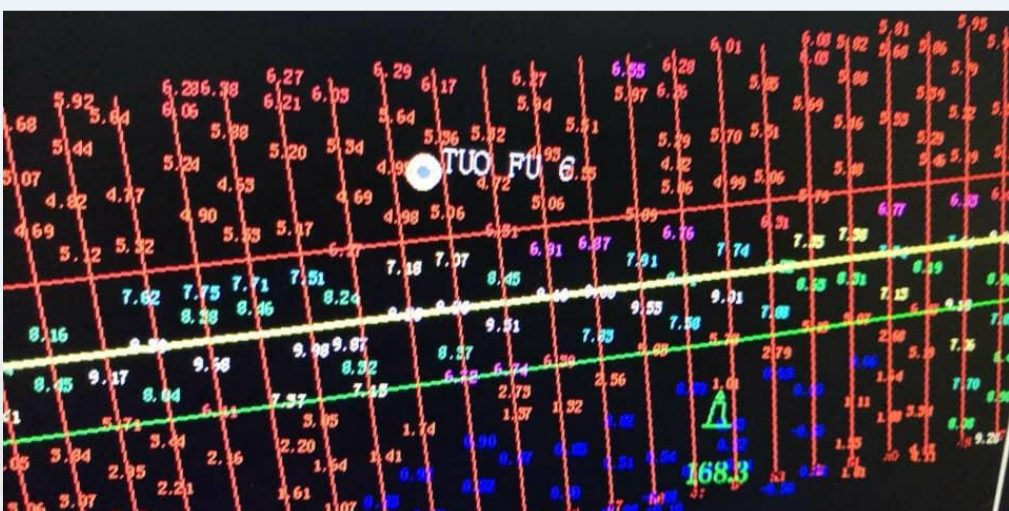
Control batimétrico (Cuantificación volumen de dragado)
