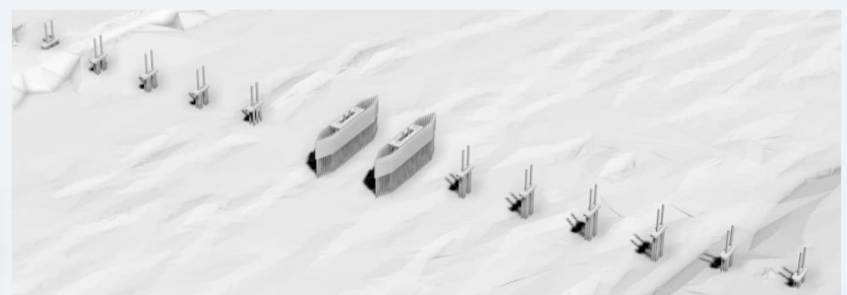
Configuración de las pilas actuales del puente María Nieves
