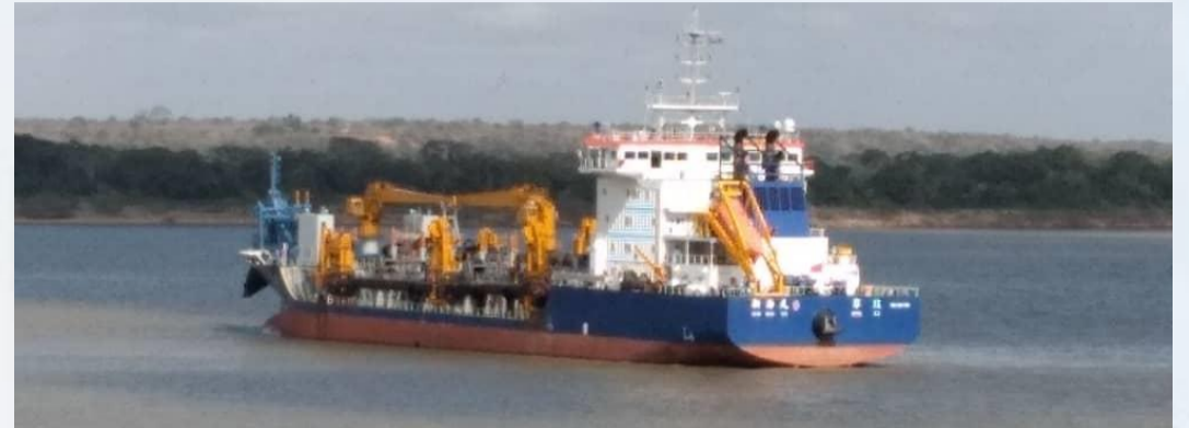
Tipo de dragas: Trailing suction hopper dredger
